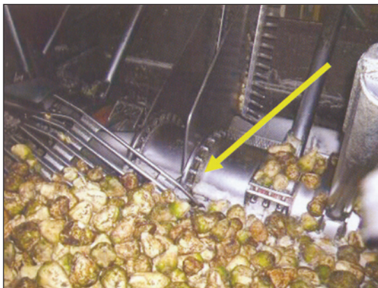
شکل شماره ۵: حوض چغندر (چغندر شویی) اصلی به صورت شکسته
